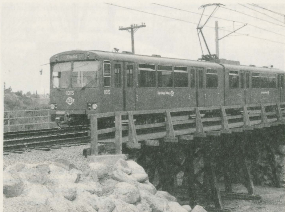
Abb. 8: Die tramway von San Diego, welche die »renaissance« dieses verkehrsmittels in den USA eingeleitet hat. Ein wagen des Frankfurter baumusters »U2«. Sein stromabnehmer und die fahrleitungsanlage bilden einen massiven historischen (temporalen und kulturalen) kontrast zu der aus holz gefertigten trestlework-brücke, die er gerade befährt. Wie so häufig in den USA wird eine frühere eisenbahntrasse genützt (teils immer noch güterverkehr), während die tramway im zentrum von San Diego im strassenplanum verkehrt. (Light Rail Review. 1.)
